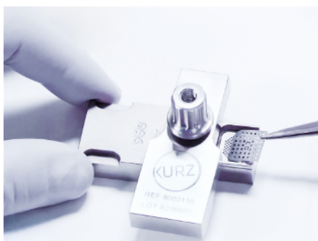
Rys. 3: Grubość płatów chrząstki = 0,7 mm minus grubość płytek dystansowych
